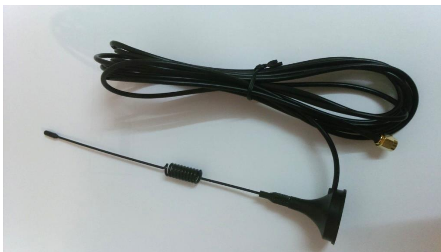
شکل ۳- آنتن‌های قابل استفاده در باند ۹۰۰ مگاهرتز
