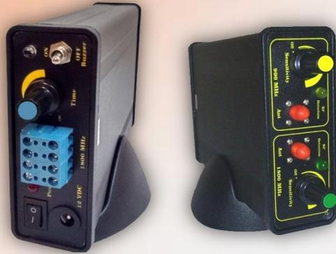
تم تصميم هذا الجهاز لاكتشاف وتحديد مرسلات الراديو المحمولة لمعايير الاتصالات الخليوية (الهواتف المحمولة وأجهزة المودم GSM 900 و 1800 و UMTS) ونقل البيانات اللاسلكي (WI FI و BLUETOOTH). يمكن للمستخدم إعداد عتبة الكشف.
